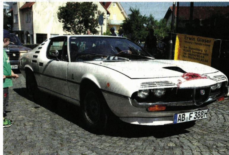
Der Alfa Romeo Montreal, mit dem Xavier und Wiltrud Adams hier starten, stammt von 1971. An der eigenwilligen Form erkennt man noch, dass bei dieser Konstruktion der Motor ursprünglich als Mittelmotor hinter den Sitzen untergebracht werden sollte. Vor Aufnahme der Serienproduktion wanderte der V8-Motor aber nach vorne unter die Motorhaube.
